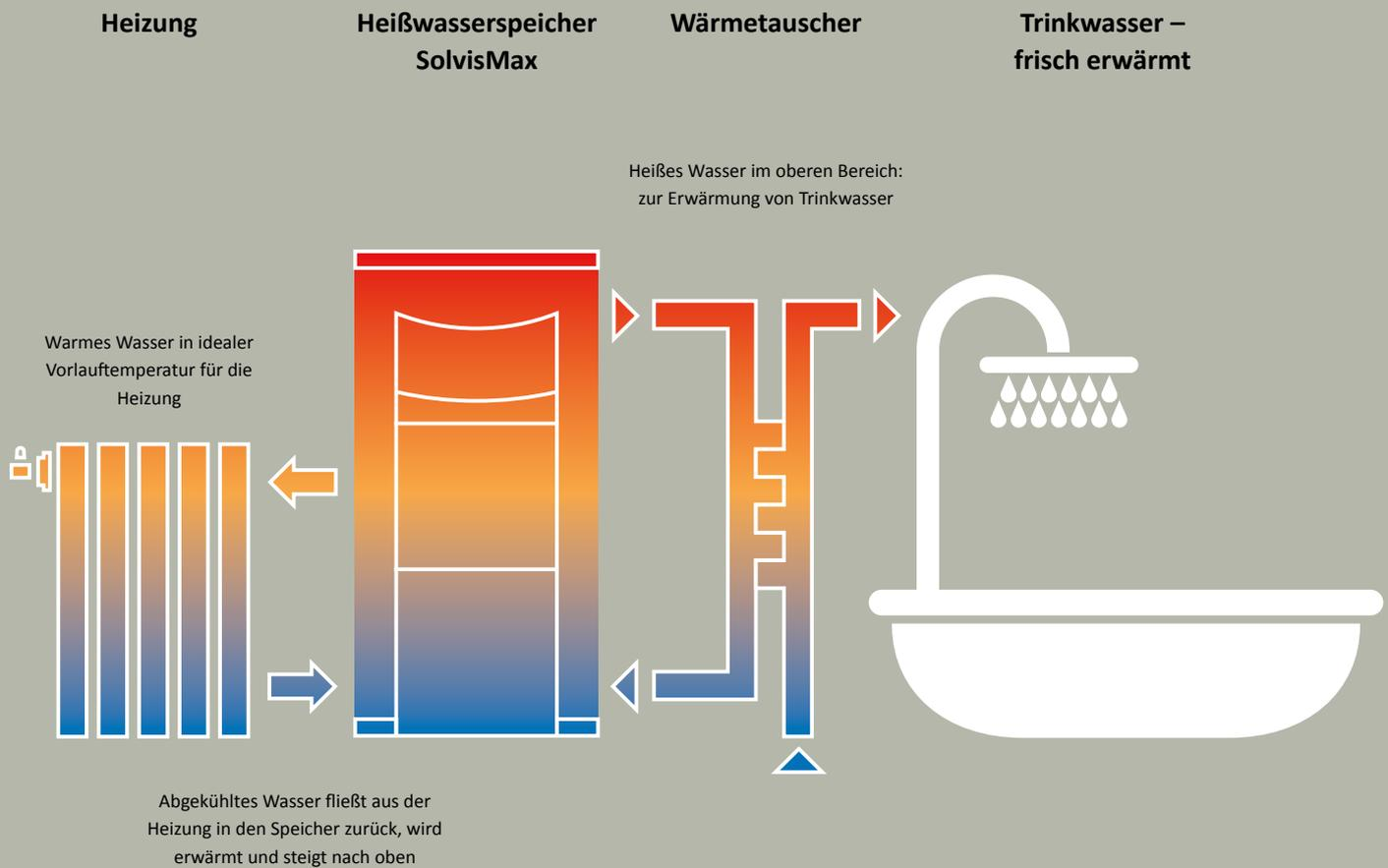
Bei herkömmlichen Heizsystemen steht der Brenner im Mittelpunkt. Beim SolvisMax ist das anders. Hier ist der Heizwasserspeicher das Herzstück der Anlage. Das Heizmodul ist integriert – und speist die Wärme direkt in den Wasserspeicher ein.
